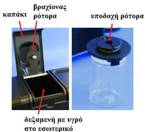
Εικόνα B.2-2: Εστίαση στο μηχανισμό τοποθέτησης δοχείου δοσιμέτρου υδρογέλης σε συγκεκριμένο σημείο εντός δεξαμενής με υγρό στο εσωτερικό συστήματος Vista 10/15 τρισδιάστατης οπτικής τομογραφίας. Ο μηχανισμός περιλαμβάνει: βραχίονα ρότορα υπό καπακιού και βάση περιστροφής δοσιμέτρου με αρπάγη δοχείου και με ειδική υποδοχή ρότορα για την πρόσδεσή της βάσης σε αυτόν.
