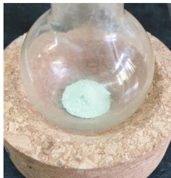
Εικόνα 7: Βρωμιούχος χαλκός μετά τον καθαρισμό.
