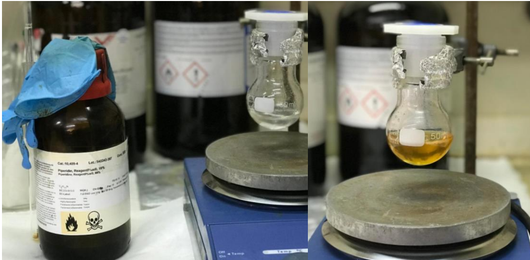
Εικόνα 18: Πλήρως προστατευμένο πολυμερές πριν και μετά την προσθήκη απεσταγμένης πιπεριδίνης. Σχηματίζεται ένα θολό υποκίτρινο διάλυμα ύστερα από έντονη ανάδευση.
