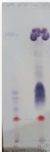
Εικόνα 42: TLC για σύγκριση εκχυλισμάτων από αλεύρι ολικής άλεσης πριν και μετά την απολίπανση (αριστερά μετά, δεξιά πριν)
