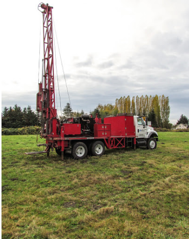
-Εικόνα 6.2: Τρυπάνι πυρήνων για γεωτρήσεις περιστροφικών δειγματοληπτικών οπών. Πηγή: «holtservicesinc.com»
