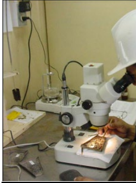
-Εικόνα 6.9: Απεικόνιση στερεομικροσκοπίου και παρατήρηση θρυμμάτων από γεωλόγο. Πηγή: «Πανεπιστημιακές σημειώσεις Κοιτασματολογία Πετρελαίου. Δρ. Α. Γεωργακόπουλος, Αριστοτέλειο Πανεπιστήμιο Θεσσαλονίκης».
