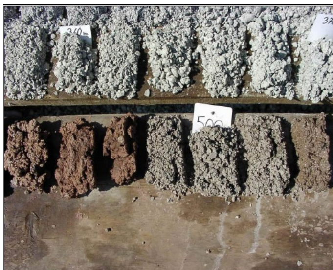
-Εικόνα 6.8: Απεικόνιση θραυσμάτων από πυρήνες δειγματοληπτικής γεώτρησης. Πηγή: «Πανεπιστημιακές σημειώσεις Κοιτασματολογία Πετρελαίου. Δρ. Α. Γεωργακόπουλος, Αριστοτέλειο Πανεπιστήμιο Θεσσαλονίκης.»
