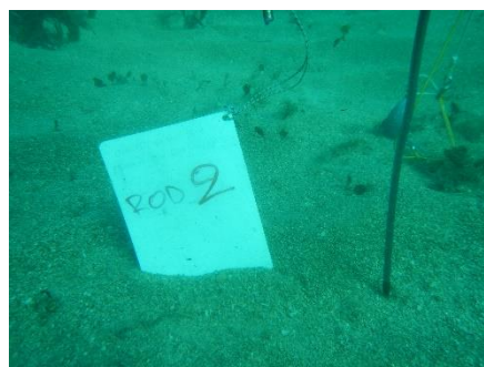
Εικόνα 4.1.6: Έμπηξη ράβδου στον πυθμένα
