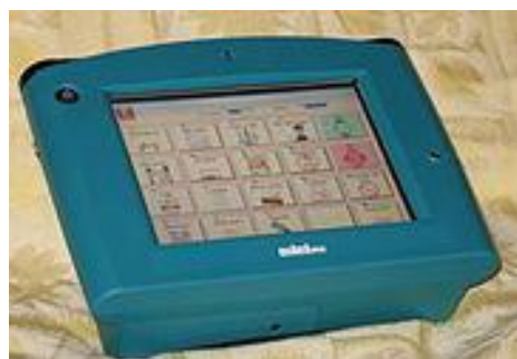
Εικόνα 4 : Υψηλής τεχνολογίας υποβοηθούμενο σύστημα ΕΕΕ - Συσκευή σύνθεσης ομιλίας
