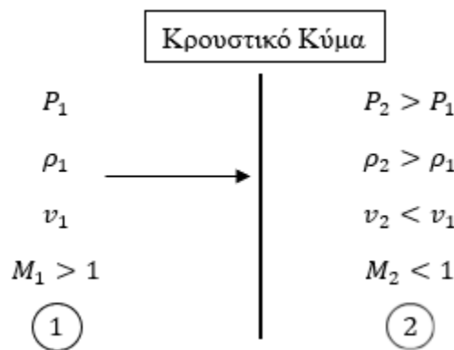
Σχήμα 3.2: Στο σύστημα της ασυνέχειας, φαίνεται πως το αδιατάρακτο αέριο κινείται προς την ασυνέχεια υπερηχητικά, ενώ το αέριο από το οποίο έχει περάσει η ασυνέχεια, κινείται υποηχητικά.
