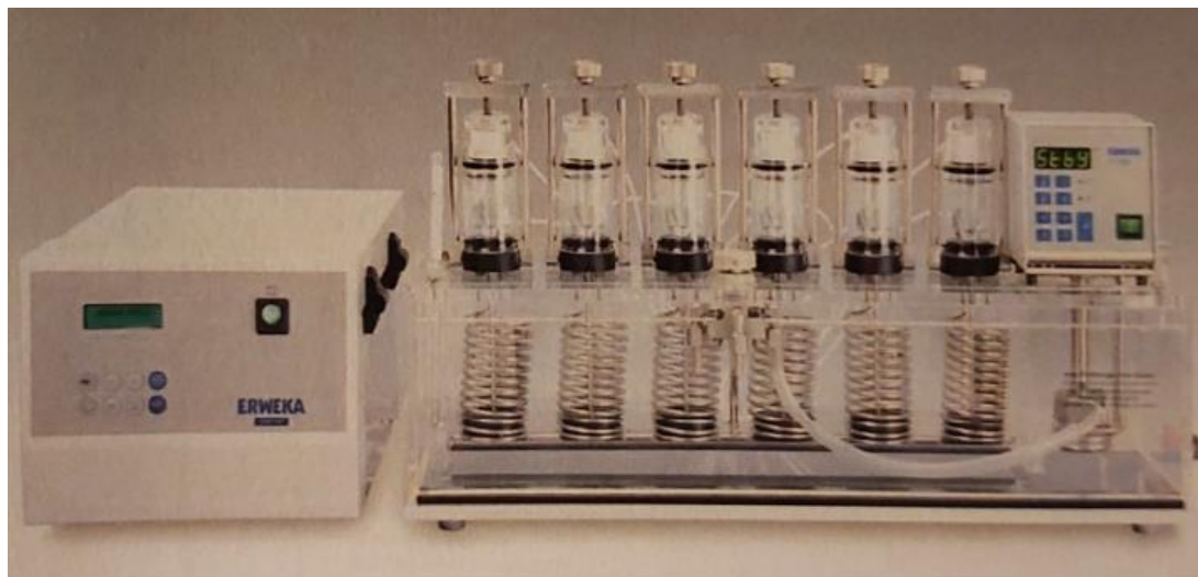
Σχήμα Β.1: Διάταξη συνεχούς ροής (Apparatus IV) (USP, 2000) Erweka που χρησιμοποιήθηκε στην παρούσα μελέτη.
