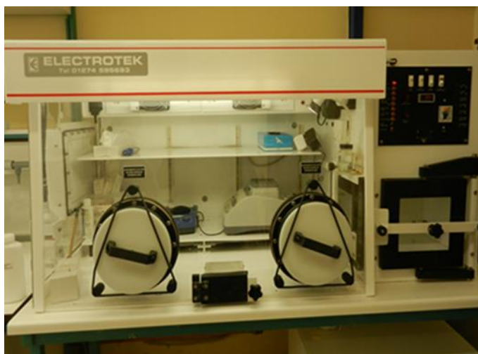
Σχήμα Β.7: Αναερόβιος θάλαμος. Αριστερά: εξωτερική άποψη αναερόβιου θαλάμου Δεξιά: το εσωτερικό του θαλάμου κατά τη διάρκεια διεξαγωγής πειράματος αποικοδόμησης.
