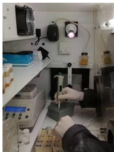
Σχήμα Β.7: Αναερόβιος θάλαμος. Αριστερά: εξωτερική άποψη αναερόβιου θαλάμου Δεξιά: το εσωτερικό του θαλάμου κατά τη διάρκεια διεξαγωγής πειράματος αποικοδόμησης.
