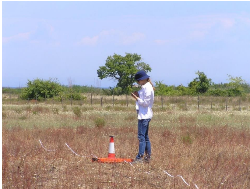
Εικόνα 4.21 Λήψη συντεταγμένων, με GPS χειρός, του κέντρου διάταξης σε κάθε βαθυσκόπηση TEM.
