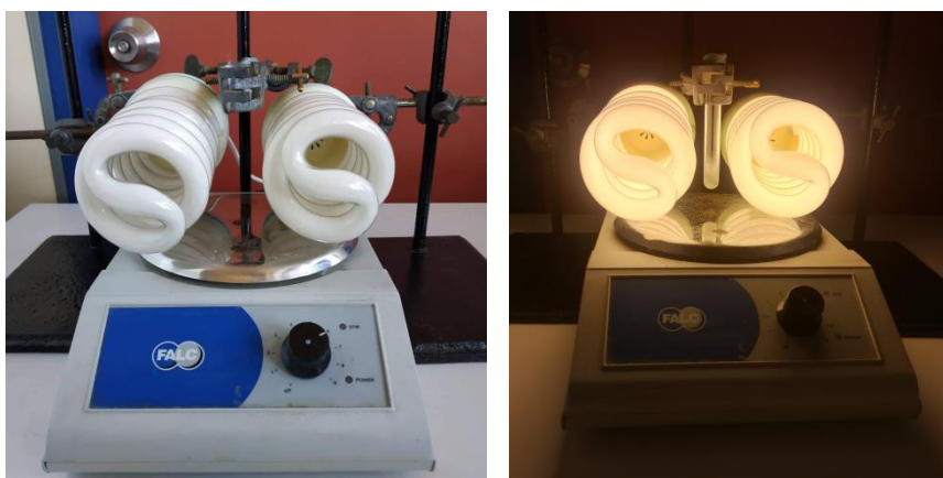
Εικόνα 5.1: Διάταξη του φωτοχημικού συστήματος για τη φωτοχημική ενεργοποίηση αλδεϊδών παρουσία θειοξανθεν-9-όνης από απλούς οικιακούς λαμπτήρες
