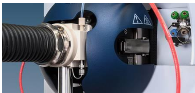
Εικόνα 9: Απεικόνιση σύγχρονης πηγής ιόντων χημικού ιοντισμού ατμοσφαιρικής πίεσης (APCI II (Bruker Daltonics, Bremen, Germany)) [30].
