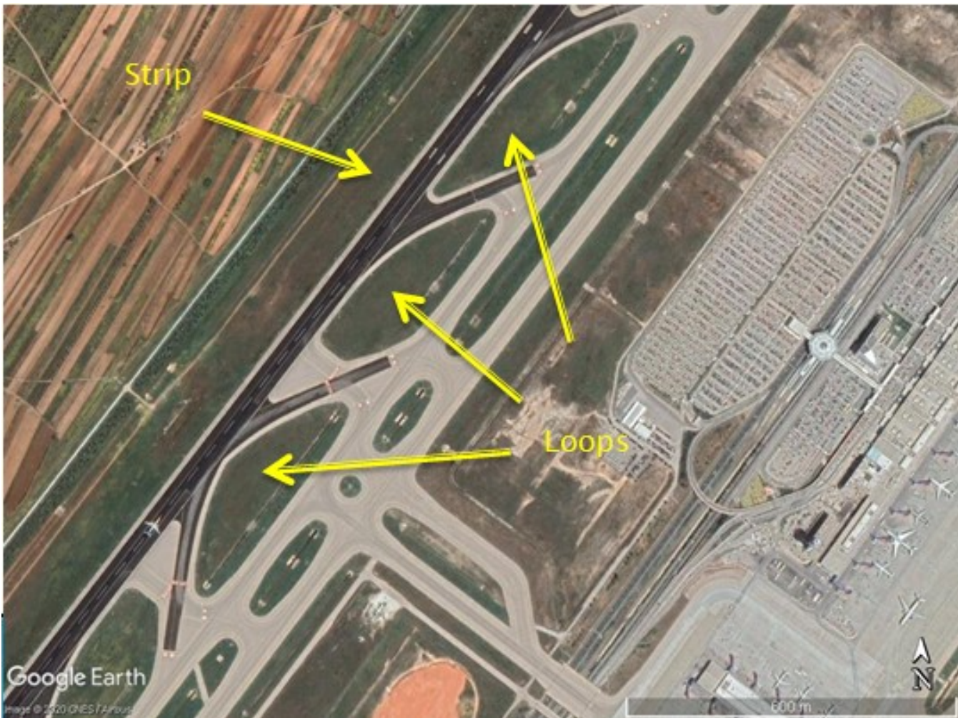
Εικόνα 1.5: Ο δυτικός διάδρομος απογείωσης-προσγειώσεων (μαύρο χρώμα) και σημειωμένα με κίτρινα βέλη τρία loops και ένα strip.
