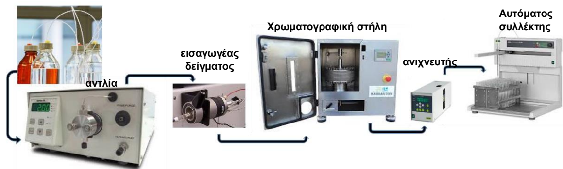
Εικόνα 25 Οργανολογία συστήματος χρωματογραφίας κατ' αντιρροή (CPC) (τροποποιημένο από Αντωνιάδη, 2019).
