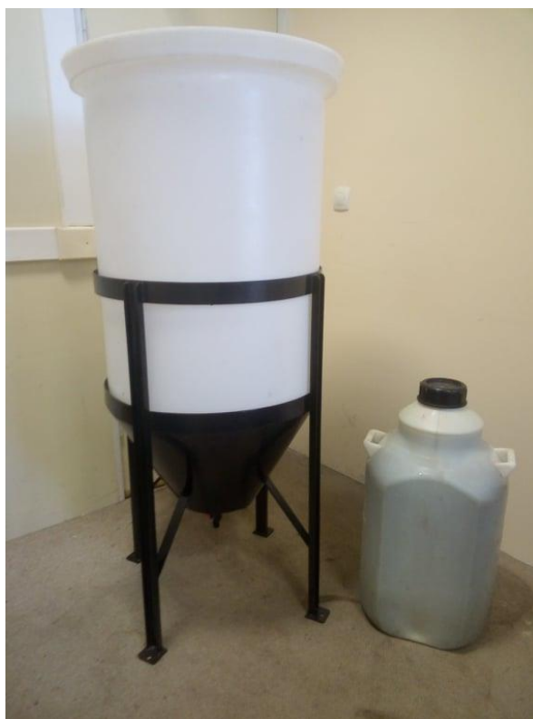
Εικόνα 5.71: Πλαστική δεξαμενή εκχύλισης.
