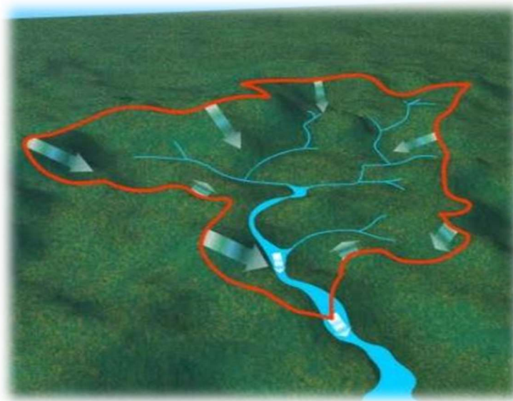
Σχήμα 1.2: Οριοθέτηση λεκάνης απορροής ( http://www.geo.auth.gr/ )
