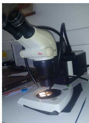
Εικόνα 3.2 Απεικόνιση του στερεοσκοπίου τύπου Leica S4E που χρησιμοποιήθηκε (φωτογραφία από προσωπικό αρχείο).
