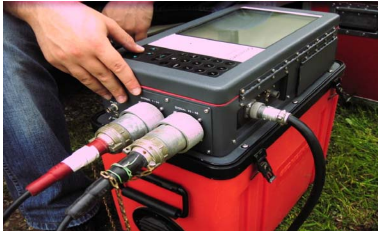
Εικόνα 5.1 Ψηφιακός σειсмоγράφος Geometrics strata view 48 καναλιών. Παρατηρούμε τρία καλώδια συνδεδεμένα με τον σειсмоγράφο. Τα δύο όμοια μεταφέρουν το σήμα από τα γεώφωνα στον σειсмоγράφο. Το τρίτο και λεπτότερο καλώδιο είναι συνδεδεμένο με τον μηχανισμό προσδιορισμού του χρόνου μηδέν (μηχανισμός triggering). Επίσης παρατηρούμε την οθόνη του σειсмоγράφου στην οποία παρουσιάζεται η καταγραφή της εδαφικής κίνησης σχεδόν αμέσως μετά την λήψη.
