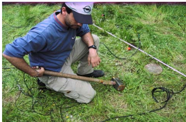
Εικόνα 5.2 Σεισμική σφύρα βάρους 5kgf. Στην σφύρα είναι συνδεδεμένος μηχανισμός προσδιορισμού του χρόνου μηδέν (μηχανισμός triggering) ο οποίος συνδέεται απ' ευθείας με τον σειсмоγράφο. Στην φωτογραφία επίσης φαίνεται η κυκλική μεταλλική πλάκα πάνω στην οποία γίνονται οι κρούσεις.
