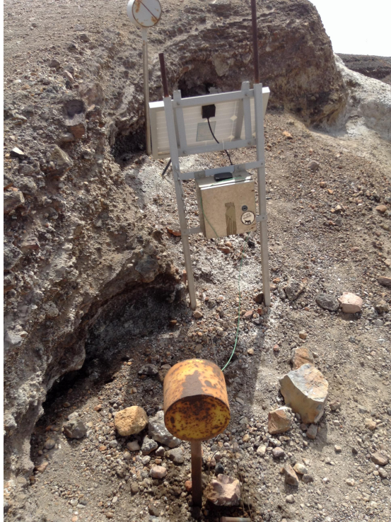
ΕΙΚΟΝΑ 1: Σταθμός θερμικής παρακολούθησης της θερμοκρασίας των ατμίδων στη Νέα Καμένη.
