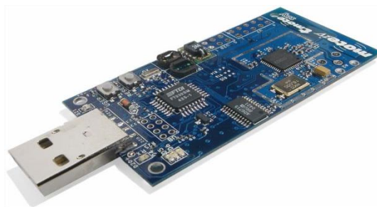
Εικόνα 5: Συσκευή Mote TelosB (Πηγή: Advanticsys)
