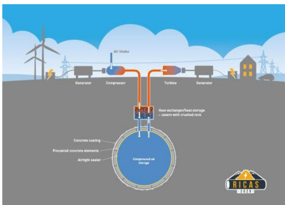
Εικόνα 3.3α: Αποθήκευση ηλεκτρικής ενέργειας με τη χρήση πεπιεσμένου αέρα [πηγή: T. Hino & A. Lejeune (2012)]
