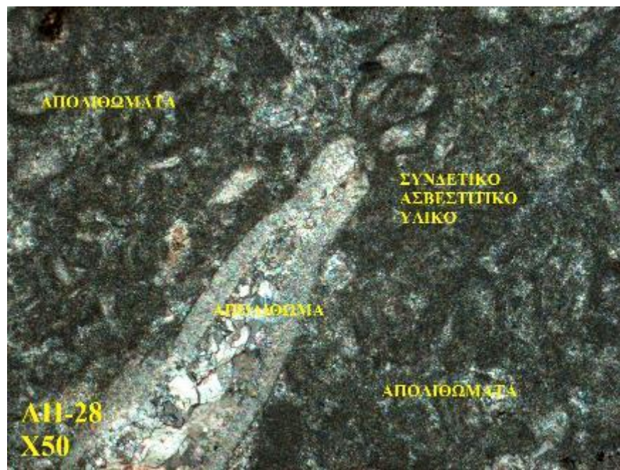
Εικόνα 6.12: Λεπτές τομές του δείγματος ΑΠΖ8 από πολωτικό μικροσκόπιο. Απεικόνιση σε μεγέθυνση x50 όπου διακρίνονται το ασβεστιτικό συνδετικό υλικό, ασβεστίτης και ποικίλα απολιθώματα.
