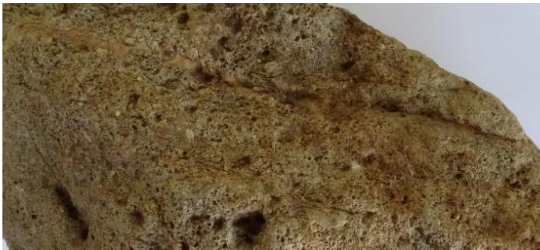
Εικόνα 8.17: Αργιλικές προσμείξεις και σιδηρούχες φάσεις τοπικά στο δείγμα ΠΖΑ-2 (απολιθωματοφόρος δολομίτης).
