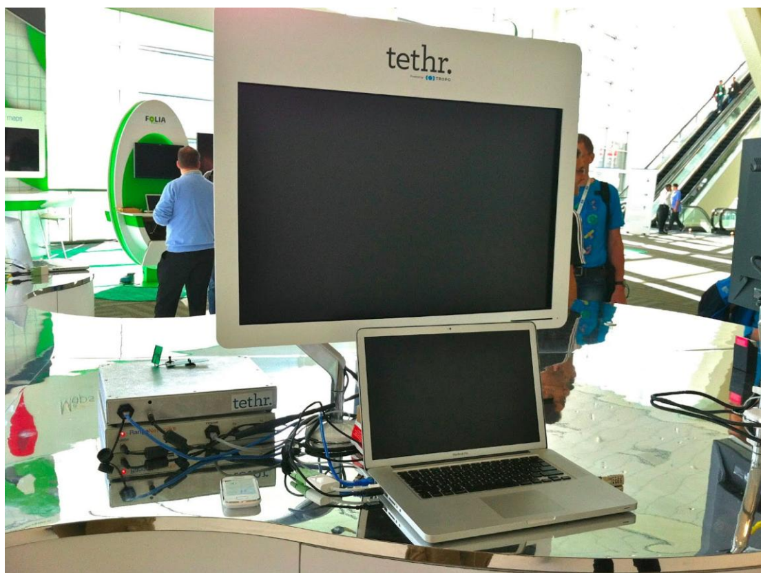
Εικόνα 6 Tethr/Tropo: Επικοινωνίες καταστροφών σε ένα χαρτοφύλακα
