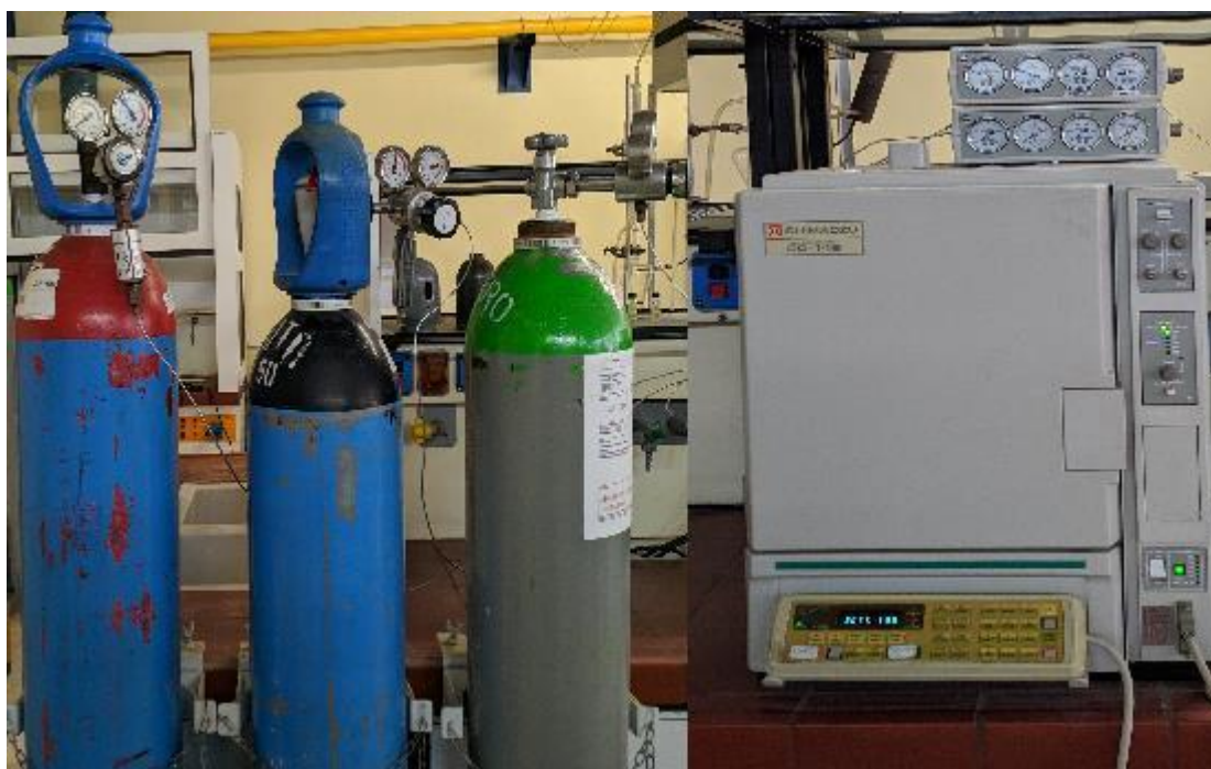
Εικόνα 8. Αέριος Χρωματογράφος, Shimadzu GC-14B.
