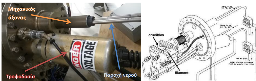
Σχήμα 2.4.: Αριστερά, το εξωτερικό του ενός κανονιού ηλεκτρονίων που βρίσκεται τοποθετημένου στον θάλαμο MBE του εργαστηρίου. Δεξιά, γραφική αναπαράσταση του εσωτερικού μηχανισμού του.
