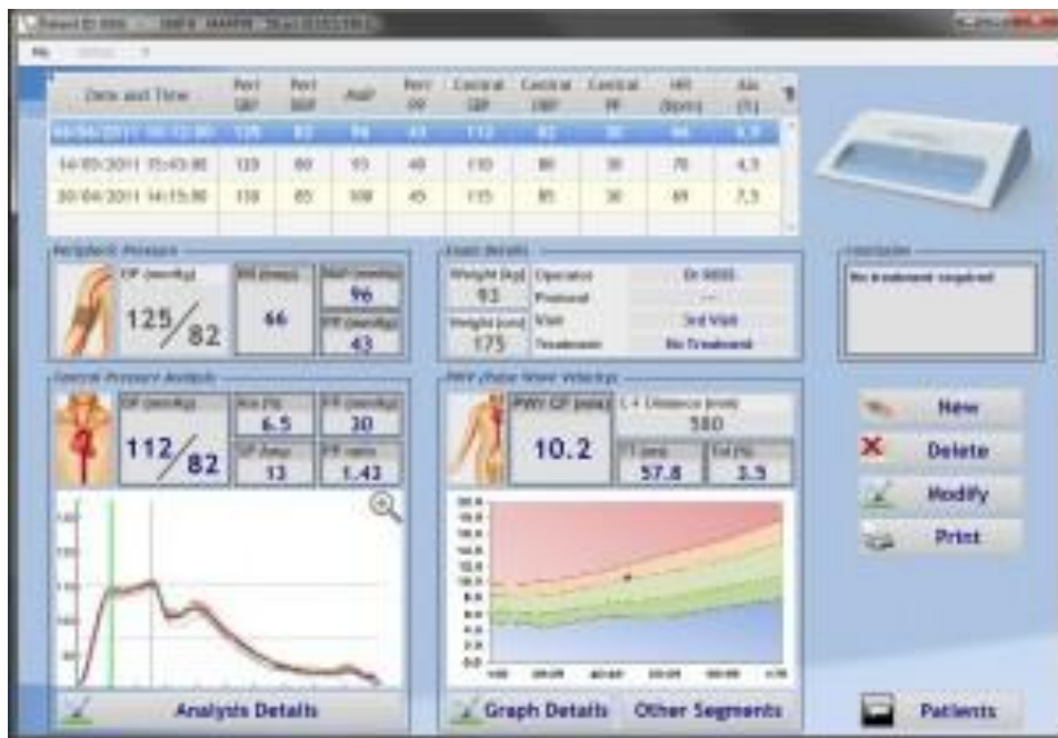
Εικόνα 12. Υπολογισμός της ταχύτητας σφυγμικού κύματος με τη συσκευή Complior Analyse (Alam Medical, France).
