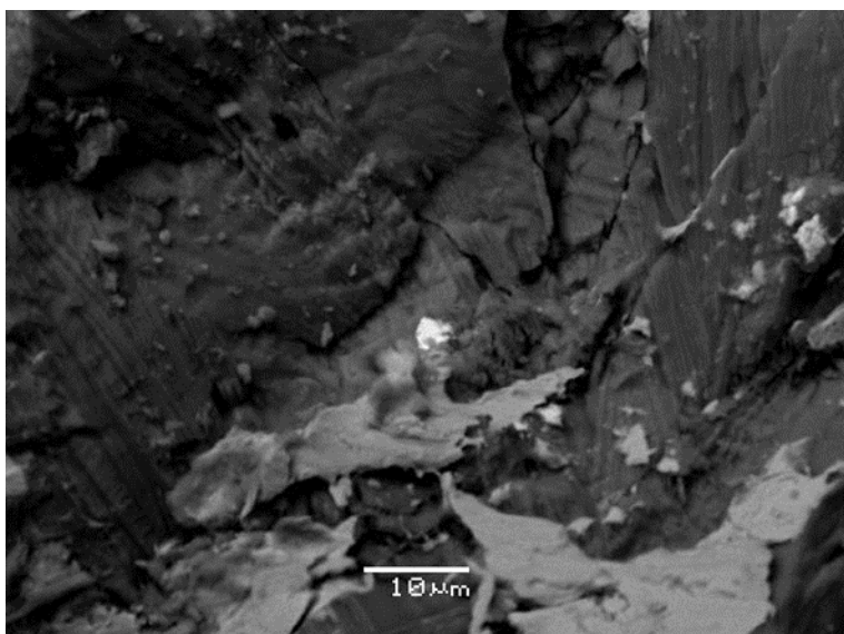
Εικ 46: Μικροφωτογραφία SEM όπου απεικονίζεται κόκκος Cu-Sn
