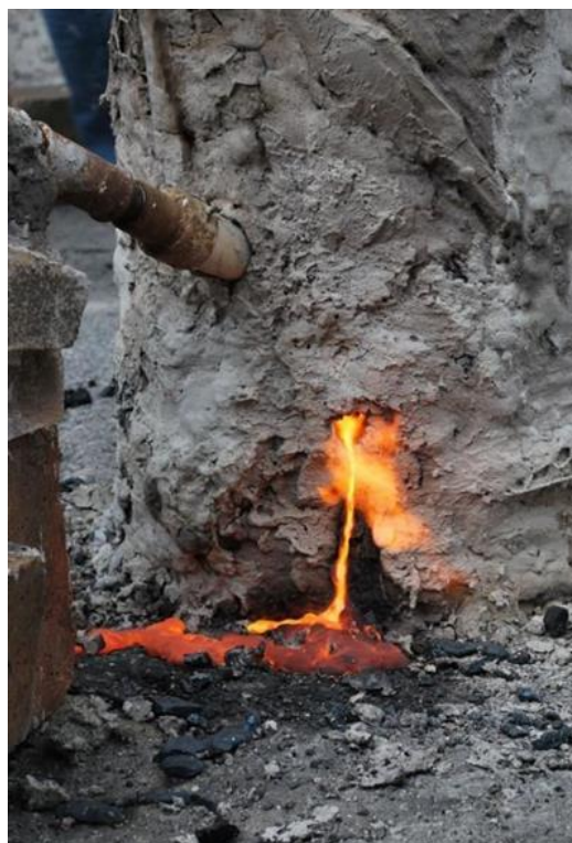
Εικόνες 8&9: Σύγχρονη ανακατασκευή φρεατώδους καμίνου (αριστερά) και ροή σκωρίας (δεξιά) [84]
