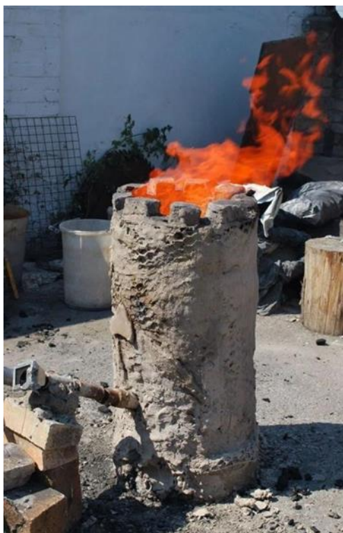
Εικόνες 8&9: Σύγχρονη ανακατασκευή φρεατώδους καμίνου (αριστερά) και ροή σκωρίας (δεξιά) [84]
