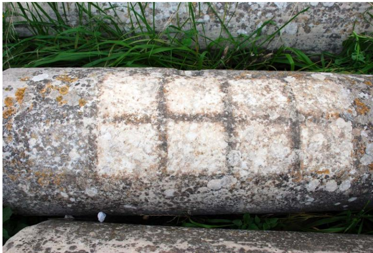
Figure 8 Ακρόπολη Αθηνών-διάσπαρτος κίονας-δοκίμες αφαίρεσης βιολογικής κρούστας
