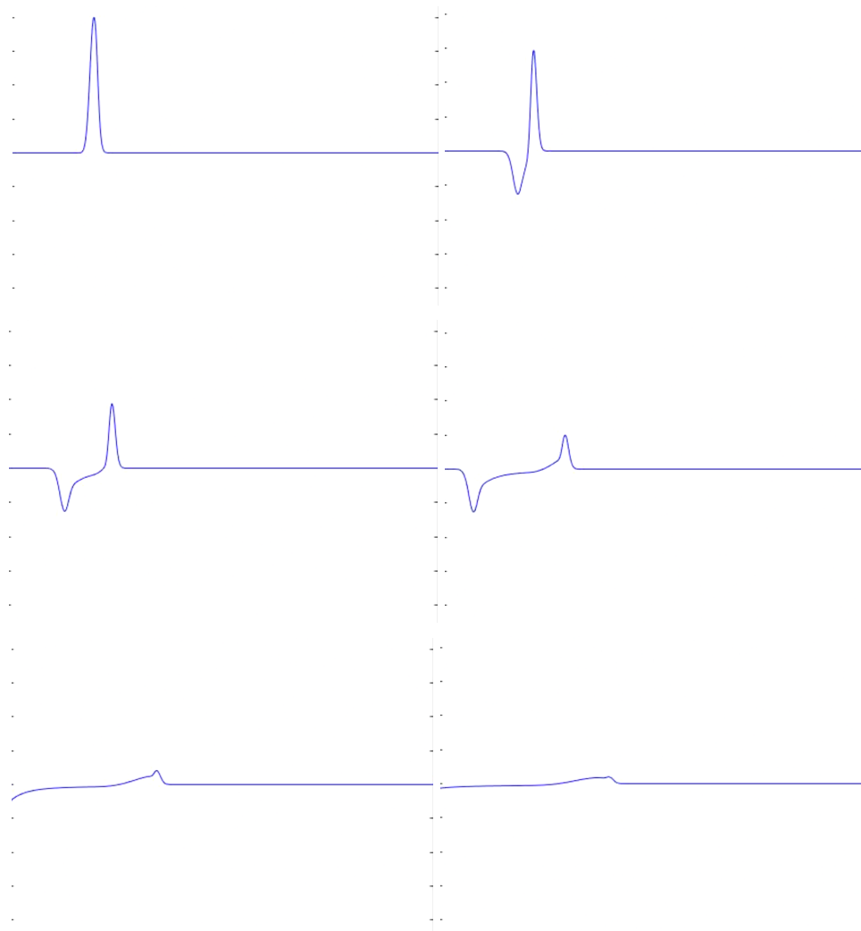
ΣΧΗΜΑ 4.2 : Μοντελοποίηση ενός γκαουσιανού παλμού ο οποίος προσπίπτει σε μέσο Debye. (Βλέπε Παράρτημα : debyeRC )
