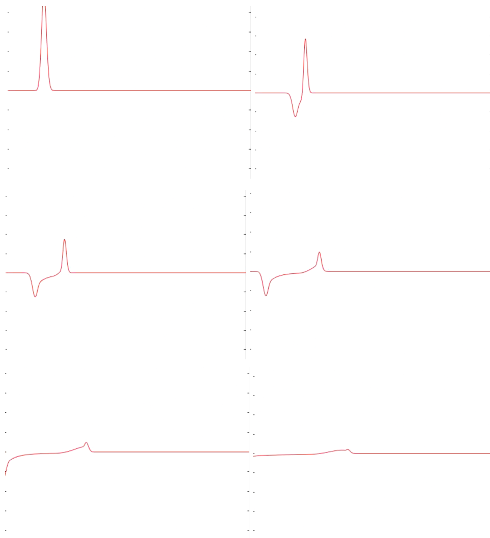
ΣΧΗΜΑ 4.3 : Μοντελοποίηση ενός γκαουσιανού παλμού ο οποίος προσπίπτει σε μέσο Debye, με την χρήση μεθόδου ADE. (Βλέπε Παράρτημα : debyeADE )
