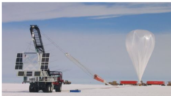
Σχήμα 1.19: Παράδειγμα στρατοσφαιρικού μπαλονιού από το πείραμα TRACER (Πηγή: http://stratocat.com.ar/ ).
