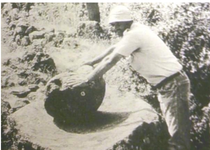
Εικόνα 26. Λίθινος τριπτήρας ελαιοκάρπου από τα Μέθανα (Κουράκου-Δραγώνα 2005, πιν. 87 εικ. 13).
