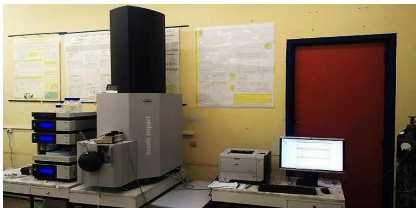
Εικόνα 12: Σύστημα υγροχρωματογραφίας συζευγμένο με φασματομετρία μαζών υψηλής διακριτικής ικανότητας τετραπόλου-αναλυτή χρόνου πτήσης (Q-ToF) [59].
