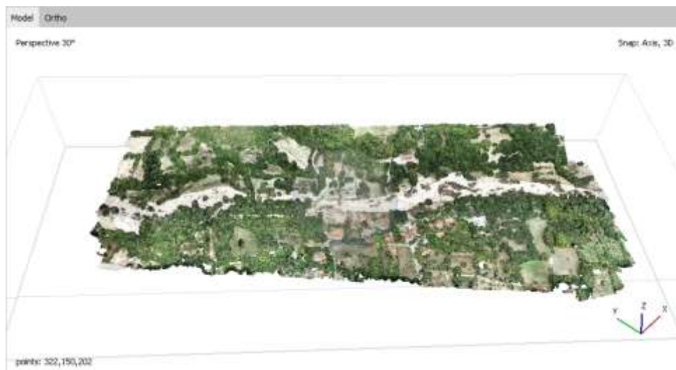
Εικόνα 5.7. Το πυκνό νέφος σημείων (dense point cloud) προκύπτει ύστερα από την ευθυγράμμιση των εικόνων στο 4 ο Βήμα.
