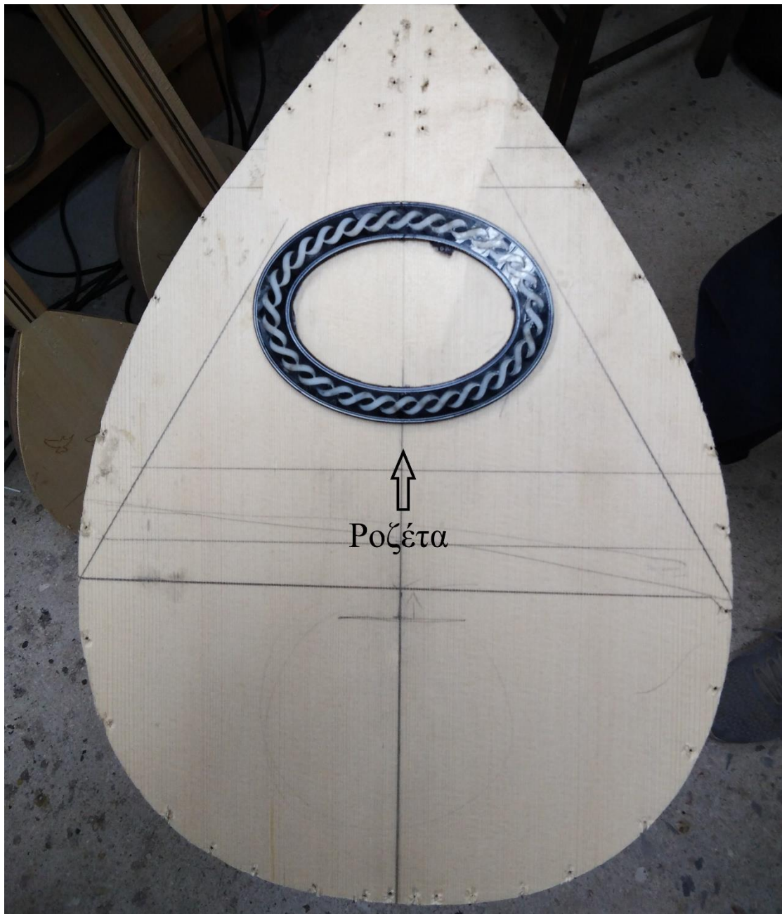
Εικόνα 5 Εξωτερική όψη του καπακιού μαζί με την ροζέτα σε πρώιμο στάδιο
