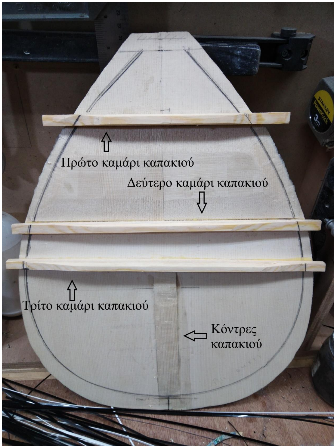
Εικόνα 4 Εσωτερική όψη του καπακιού σε πρώιμο στάδιο
