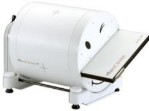
Εικόνα 4.2: Το ομοίωμα Octavius 4D της εταιρείας PTW. Το συγκεκριμένο προορίζεται και για περιοδικούς ελέγχους ποιότητας, αλλά και για εξατομικευμένους ελέγχους επιβεβαίωσης πλάνων ακτινοθεραπείας ( https://www.ptwdosimetry.com/application-pages/patient-qa-solutions/?L= ).
