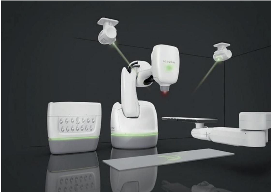
Εικόνα 1.5: Το πιο πρόσφατο εμπορικά διαθέσιμο CyberKnife™, το M6 με ρομποτικό βραχίονα 6 βαθμών ελευθερίας και τράπεζα θεραπείας RoboCouch™ επίσης 6 βαθμών ελευθερίας ( https://link.springer.com/chapter/10.1007/978-3-030-50668-1_3 ).
