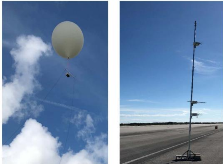
Σχήμα 28 Πειραματική εγκατάσταση του συστήματος RTD κάτω από μετεωρολογικό μπαλόνι (αριστερά) και σε τηλεσκοπικό ιστό (δεξιά) [23]
