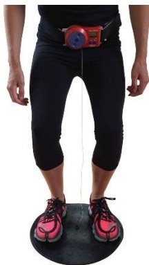
Εικόνα 2.2.2 Συσκευή μέτρησης κατακόρυφου άλματος
