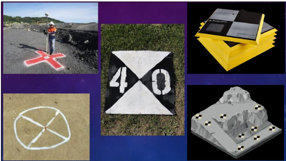
Εικόνα 4.4: Σημεία ελέγχου εδάφους/φωτοσταθερά σημεία (Ground Control Points)
