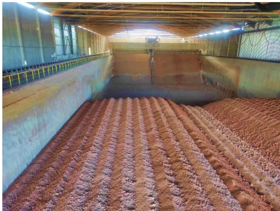
Εικόνα 9: Εργοστάσιο Καμαρίου - Σωρός Τόφφου - Μέθοδος Windrow
