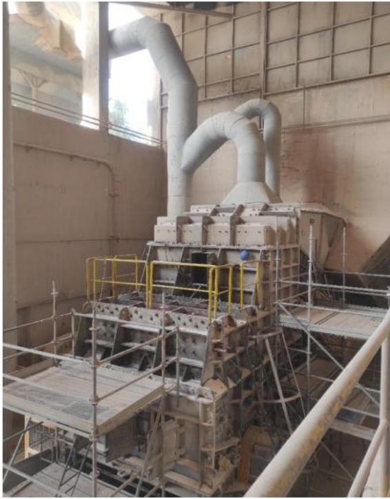
Εικόνα 5: Εργοστάσιο Καμαρίου - Αριστερά: Σφυροθραυστήρας Ασβεστολίθου υπό συντήρηση. Δεξιά: Διπλός σφυροθραυστήρας τόφφου. Ο πάνω σφυροθραυστήρας είναι κατασκευασμένος να δέχεται μεγαλύτερα σε όγκο τμήματα του τόφφου. Τα θραυσμένα τμήματα παίρνουν στον δεύτερο θραυστήρα για περαιτέρω επεξεργασία.
