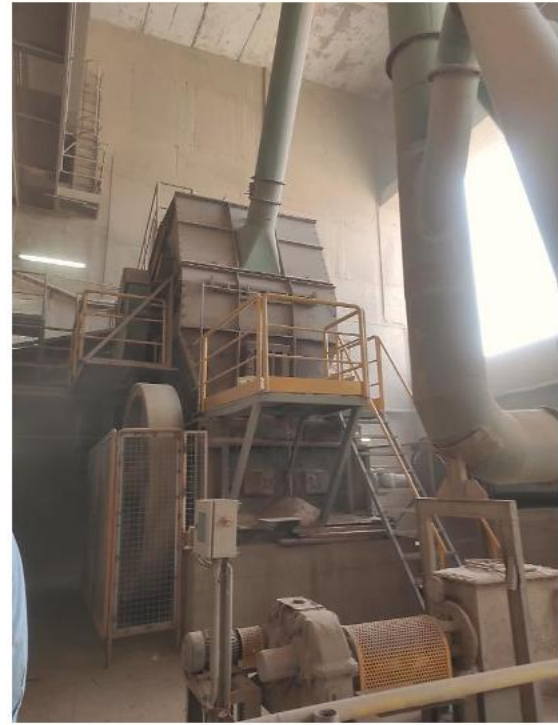
Εικόνα 5: Εργοστάσιο Καμαρίου - Αριστερά: Σφυροθραυστήρας Ασβεστολίθου υπό συντήρηση. Δεξιά: Διπλός σφυροθραυστήρας τόφφου. Ο πάνω σφυροθραυστήρας είναι κατασκευασμένος να δέχεται μεγαλύτερα σε όγκο τμήματα του τόφφου. Τα θραυσμένα τμήματα παίρνουν στον δεύτερο θραυστήρα για περαιτέρω επεξεργασία.
