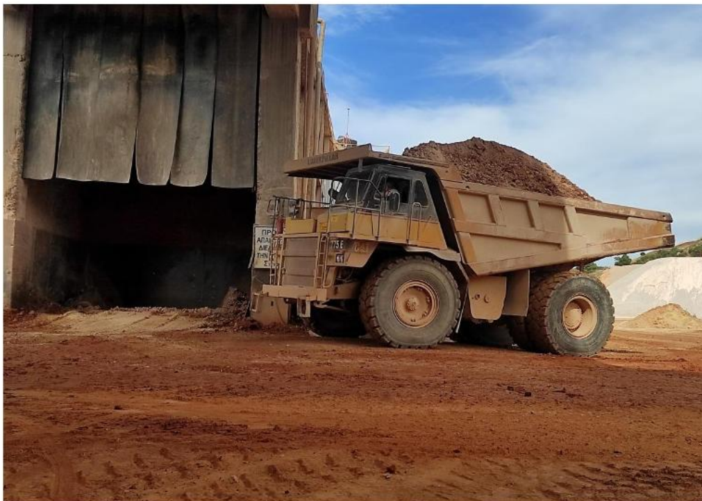
Εικόνα 4: Εργοστάσιο Καμαρίου - Βαρέως τύπου οχήματα (dump trucks) μεταφέρουν το εξορύξιμο υλικό από το λατομείο στις χοάνες που οδηγούν στους θραυστήρες. Τα υλικά οδηγούνται σε θραύση και έπειτα μέσω ταινίας στους σωρούς προ - ομοιογένειας.
