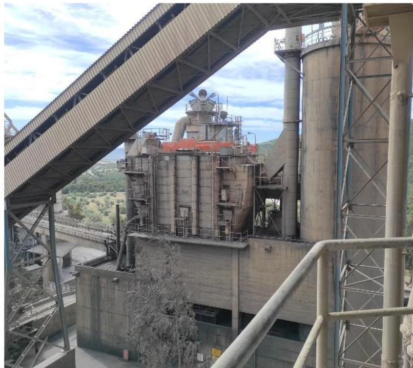
Εικόνα 60: Εργοστάσιο Καμαρίου – Πάνω: δείγμα άνθρακα. Κάτω: Συγκρότημα μύλου άλεσης άνθρακα
