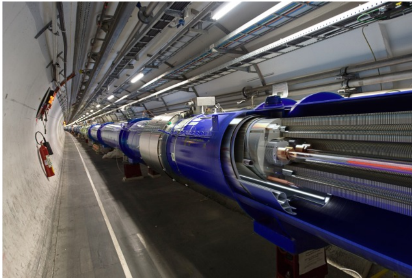
Σχήμα 2.1: 3D διατομή ενός διπολικού μαγνήτη του LHC [23].
