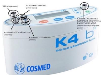
Εικόνα 2.9: Βύσματα σύνδεσης στον φορητό αναλυτή K4B 2
