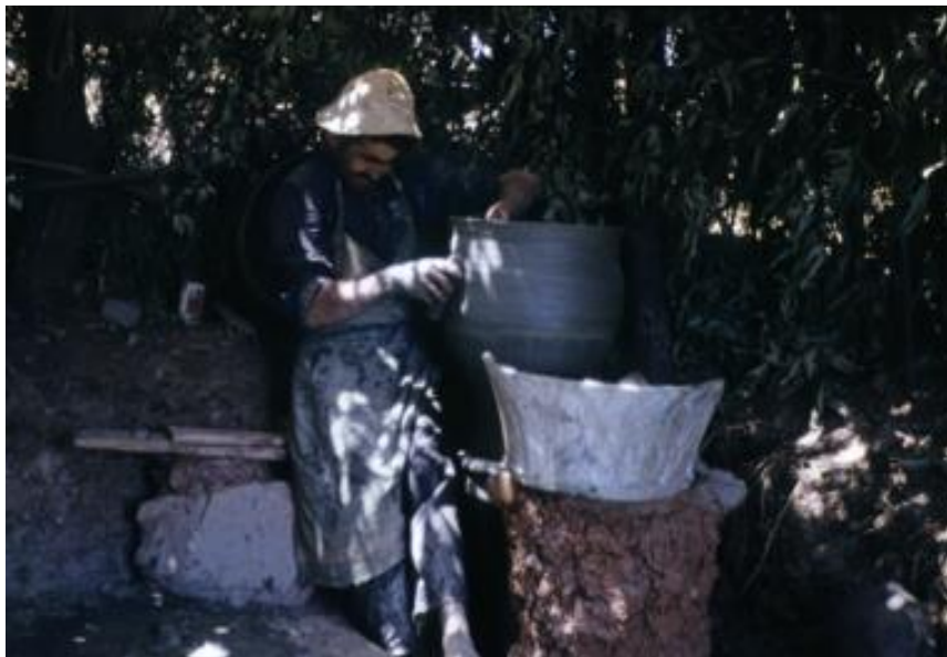
Εικόνα 2. Αγγειοπλάστης που κατασκευάζει μικρά «στομωτά» αγγεία στον ποδοκίνητο τροχό. Κρήτη 1962. Φωτογραφικό αρχείο του Πανεπιστήμιου της Χαϊδελβέργης – Ινστιτούτο Κλασικής Αρχαιολογίας. https://heidicon.ub.uni-heidelberg.de/detail/664891 , 20/01/2022.
