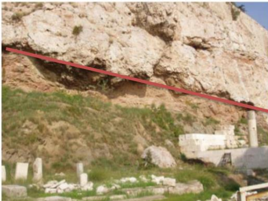
Εικόνα 2.14. Επαφή ασβεστολιθικών και υποκείμενων σχηματισμών στη νότια κλιτή του λόφου (Koukis et al., 2015).
