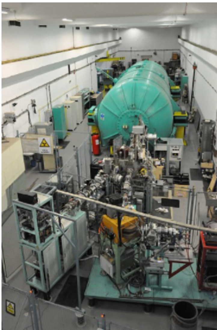
Εικόνα 3.1: Φωτογραφία του επιταχυνητή 9MV FN Pelletron Tandem Van de Graaff του IFIN-HH [39]. Σε πρώτο πλάνο εμφανίζονται οι πηγές ιόντων της διάταξης και ακολουθεί η κύρια δεξαμενή του επιταχυνητή.
