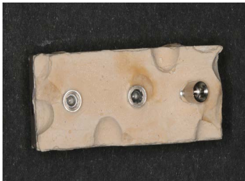
Εικ. 3 Πρότυπο δοκίμιο από εποξική ρητίνη με τα εμφυτεύματα Α,Β,С
