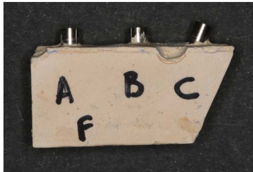
Εικ. 4 Πρότυπο δοκίμιο από εποξική ρητίνη με τα εμφυτεύματα Α,Β,С
