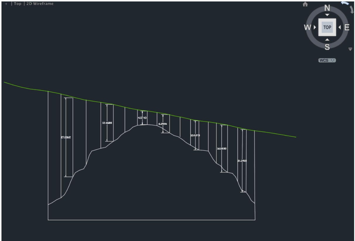
Εικόνα 22. Επεξεργασία διατομής με το λογισμικό AUTOCAD 2019 για μέτρηση του κενού χώρου ανάμεσα στην επιφάνεια του εδάφους και την οροφή του σπηλαιού.
