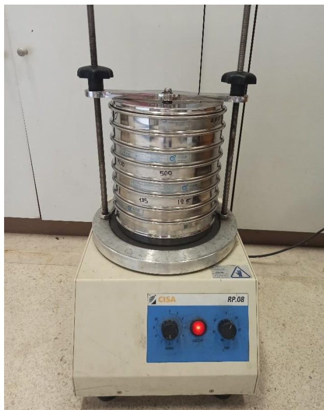
Εικόνα 4.4: Κάθετη διάταξη των κοσκίνων στην συσκευή δόνησης (σλλογή συγγραφέα)
