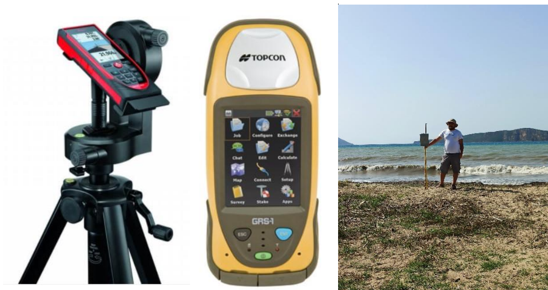
Εικόνα 4.1: α) Αποστασιόμετρο τύπου Leica (Laser Distance Meter) ( https://www.geoshop.gr/product/leica-set-disto-s910/ ), β) Συσκευή GPS ( https://topconcare.com/en/hardware/gnss-receivers/grs-11/ ), γ) Πινακίδα Στόχευσης (συλλογή συγγραφέα)
