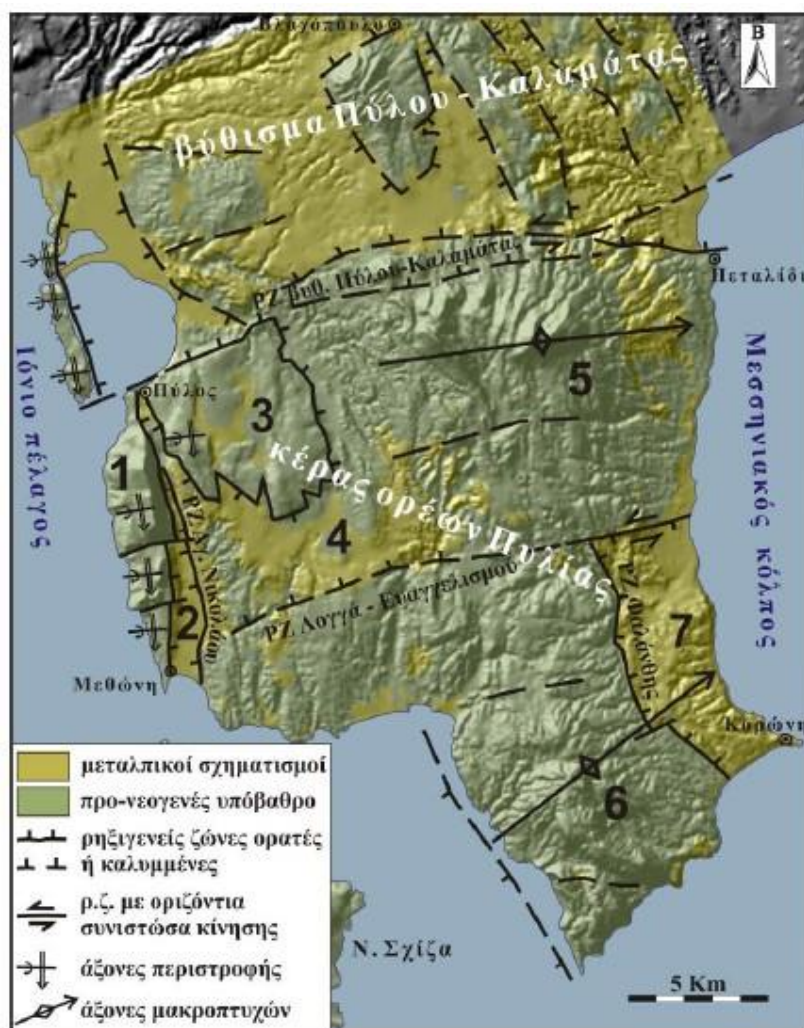
Εικόνα 3.6: Οι κύριες ρηξιγενείς ζώνες και οι μικρότερης τάξης δομές στην χερσόνησο της Πυλίας (1: κέρασ Αγίου Νικολάου, 2: βύθισμα Πύλου – Μεθώνης, 3: κέρασ Κυνηγού, 4: λεκάνη Πήδασσου, 5: μορφοτεκτονική δομή Λυκόδημου, 6: κέρασ Μαυροβουνίου, 7: βύθισμα Φαλάνθης) (Ladas et al., 2004).
