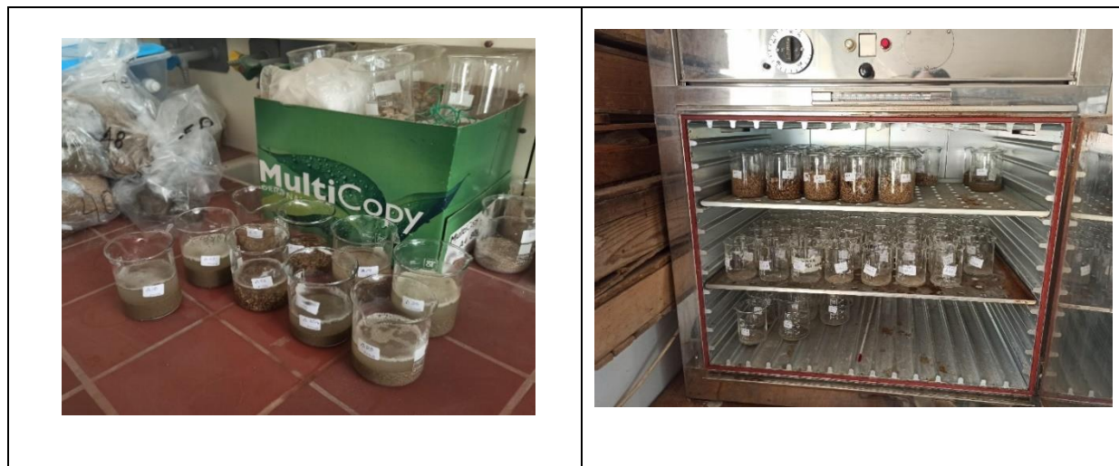
Εικόνα 4.3: (α) Δοκιμαστικά δοχεία κατά την διάρκεια της έκπλυσης των ιζημάτων με γλυκό νερό (συλλογή συγγραφέα) και β) Φούρνος ξήρανσης των δειγμάτων σε θερμοκρασία 60°C (συλλογή συγγραφέα)
