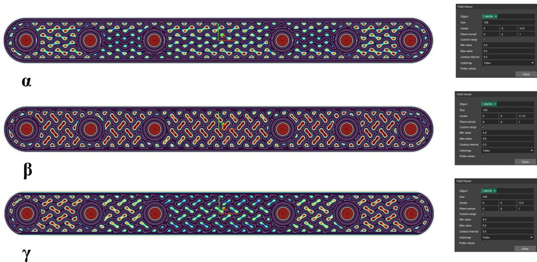
Εικόνα 28: Τομές στο επίπεδο x-y της νέας πλάκας α) 0.5 mm, β) 1.75 mm και γ) 2.5 mm του πάχους της. Με σκούρο μπλε απεικονίζονται τα στοιχεία με απόσταση μικρότερη ή ίση των 300 μm και με σκούρο κόκκινο τα στοιχεία με απόσταση μεγαλύτερη ή ίση των 600 μm.
