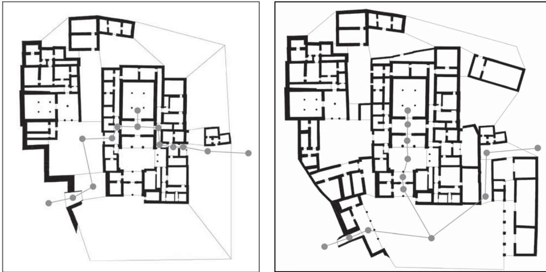
Εικ.101 Πύλος, Ανακτορικό Συγκρότημα, ΥΕ ΠΙΒ περίοδος. Οι συντομότερες δίοδοι πρόσβασης στην Αίθουσα του Θρόνου, και οι αλλαγές ανάμεσα στην αρχική και τελική αρχιτεκτονική φάση του ανακτόρου.
