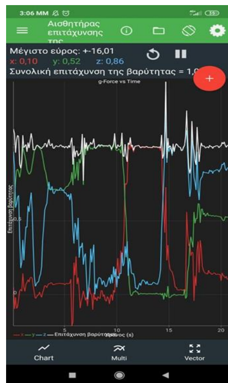
Εικόνα 3.1. ΑΡΙΣΤΕΡΑ: Απεικονίζονται οι τρεις διευθύνσεις X (πλάγια), Y (κατακόρυφος), Z (προσθιοπίσθια) στο σημείο τοποθέτησης του κινητού τηλεφώνου. ΔΕΞΙΑ: Απεικονίζεται στην οθόνη του κινητού τηλεφώνου η λειτουργία G-Force Meter της εφαρμογής Physics Toolbox.
